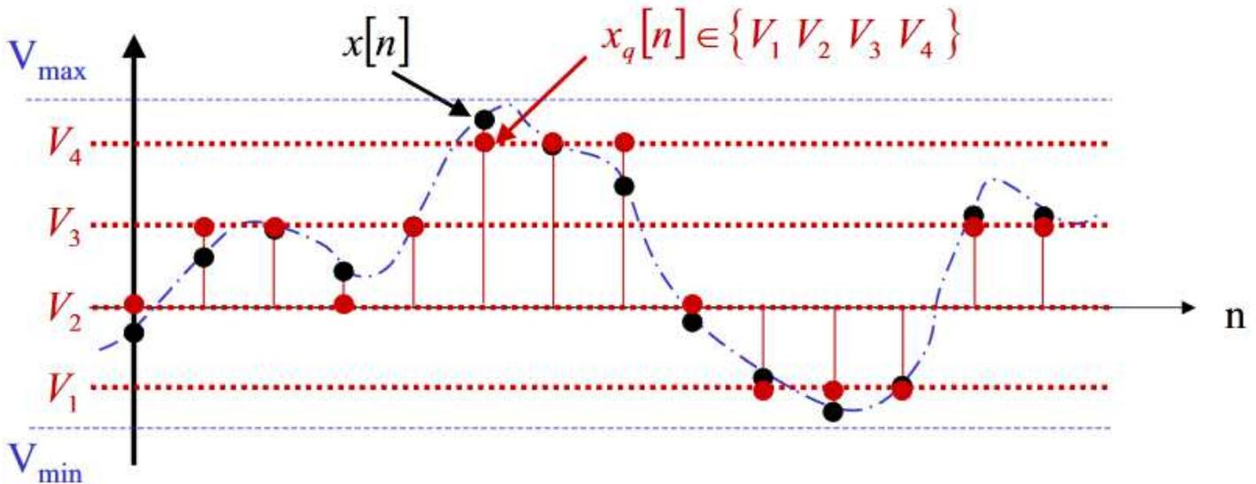
Il quantizzatore  $e'$  dunque un sistema non lineare che riceve in ingresso il **numero reale continuo  $x[n]$**  e restituisce in uscita il **valore piu' vicino a  $x[n]$  fra gli  $M$  possibili livelli di quantizzazione  $V_1, \dots, V_M$** .
